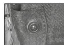
Inserir os parafusos nas anilhas do cinto. Voltar a inserir os parafusos nos orifícios de fixação e apertá-los.
