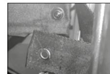
Retirar los tornillos ubicados en la parte inferior, de cada lado del respaldo de la silla.
